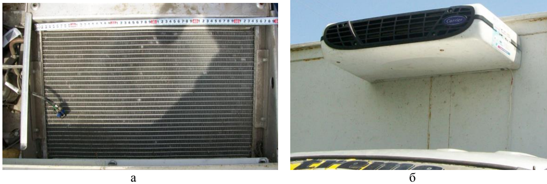
Рис. 1 – Експериментальна модель: а – мікроканалний повітряний конденсатор; б – транспортна холодильна установка
