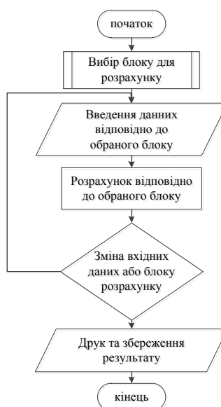
Рис. 3 – Спрощений алгоритм розрахунку мікроканалного конденсатора
